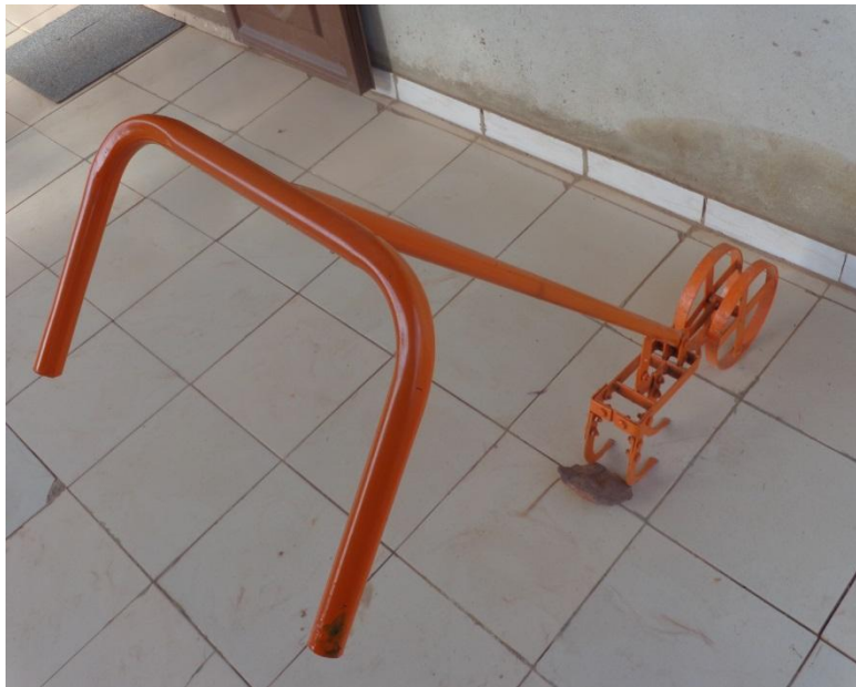
Figure 8. Imported wheel hoe weeder used in study. Source: Société Coopérative Artisanale des Forgerons à l'Office du Niger, Mali (SOCAFON), 2016
